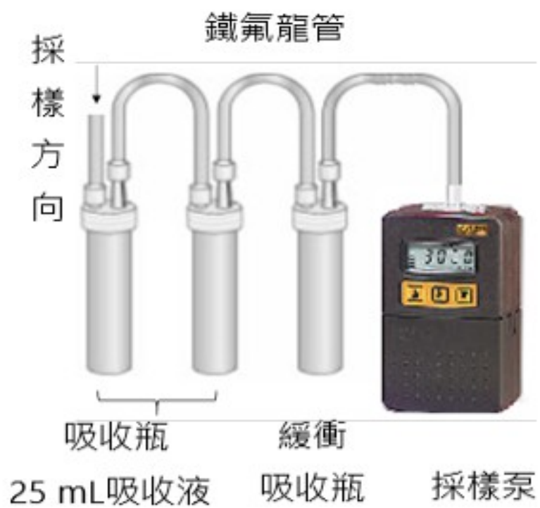
圖一 採樣設備配置圖
