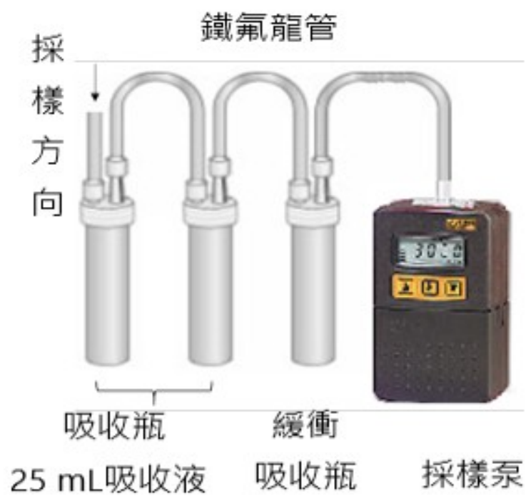
圖一 採樣設備配置圖
