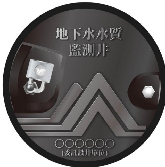
註：防水手孔蓋之直徑以 8~12 吋為原則；手孔蓋上建議設計井鎖放置位置，以避免造成人員及車輛出入之不便及危險；手孔蓋上方需刻劃「地下水水質監測井」，下方需刻劃委託監測井設置單位名稱；另於表面增設防滑設計（示意圖以行政院環境保護署標幟表示）。
