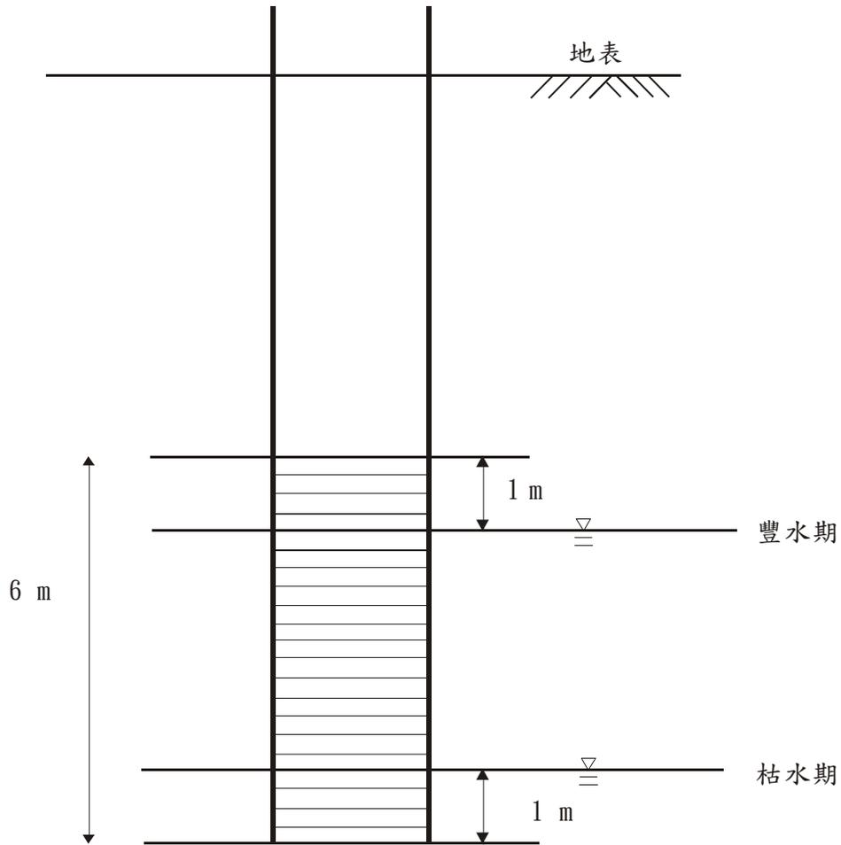
圖二 非受壓含水層在豐水期和枯水期鑽孔深度及井篩位置示意圖(未按比例)
