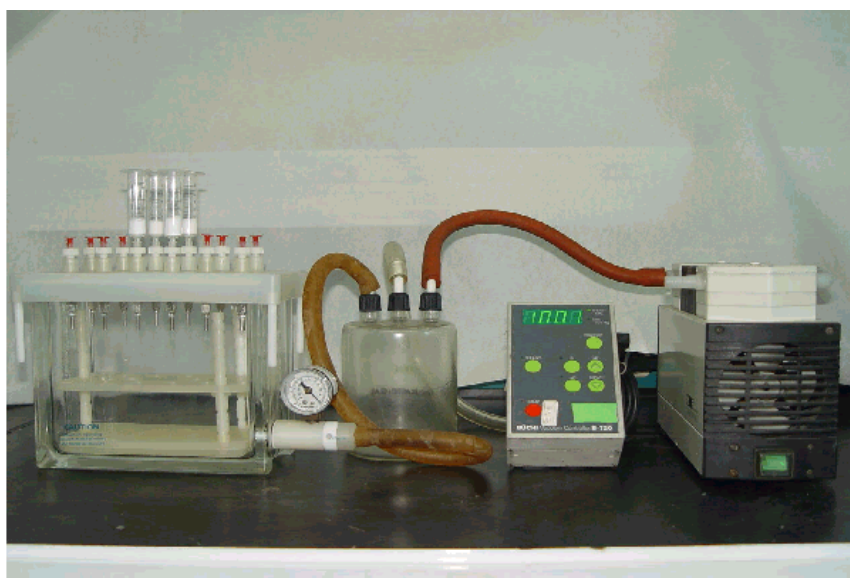
圖三 手動固相萃取管（Cartridge）萃取裝置
