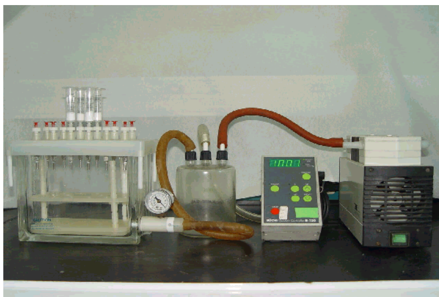
圖三 手動固相萃取管 (Cartridge) 萃取裝置
