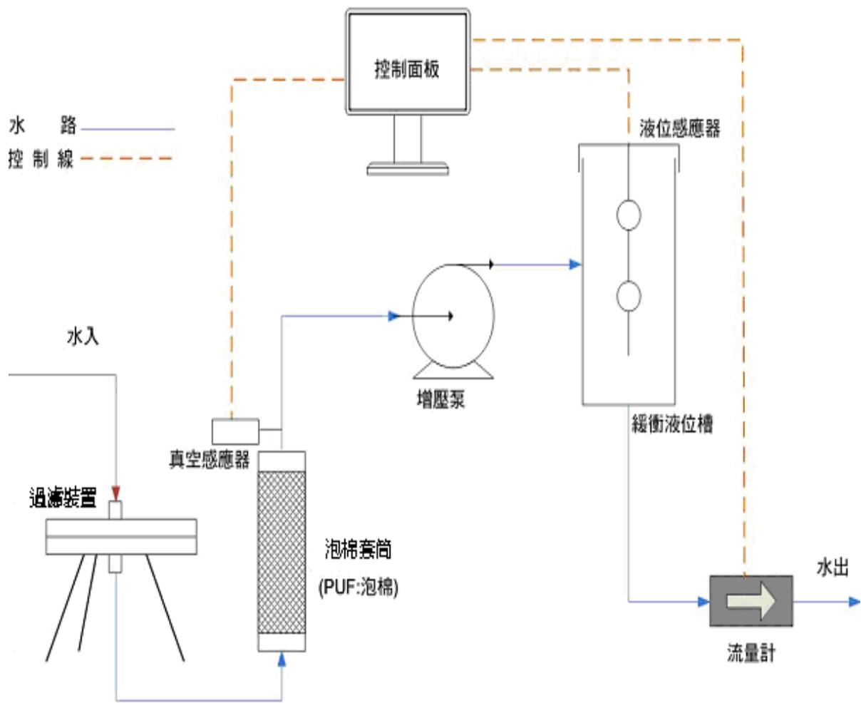
圖一 前濃縮水質採樣器示意圖
