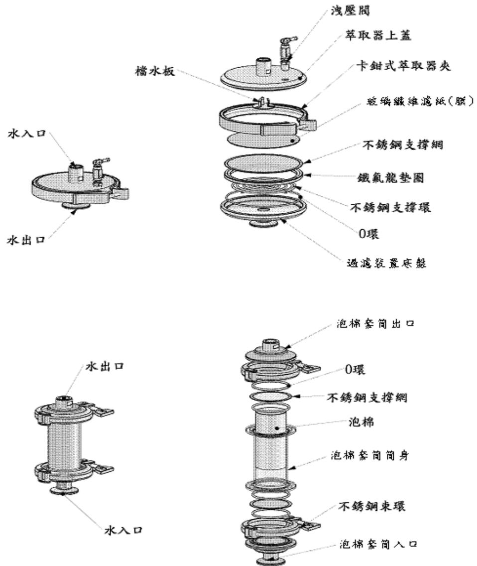
圖二 採樣頭示意圖(含過濾裝置及泡棉套筒)
